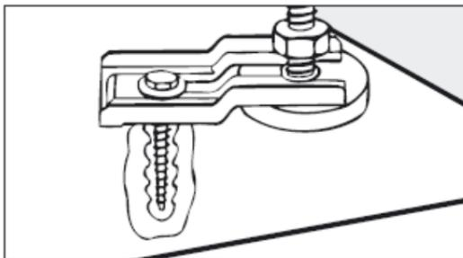
С помощью прилагаемых крепящих уголков прибор можно за ножки закрепить прямо к полу. Крепеж рассчитан на дюбельное крепление к бетонному полу.
