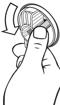
**⚠** Закройте отверстия удаленного транспортировочного крепления! При незакрытых отверстиях существует опасность повреждения.
